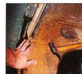
Le plancher AV gauche est très corrodé, comme en témoignent les perforations que l'on voit non loin de la trappe de visite du maître-cylindre.
