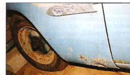
Au bas des ailes, la corrosion est perforante.
