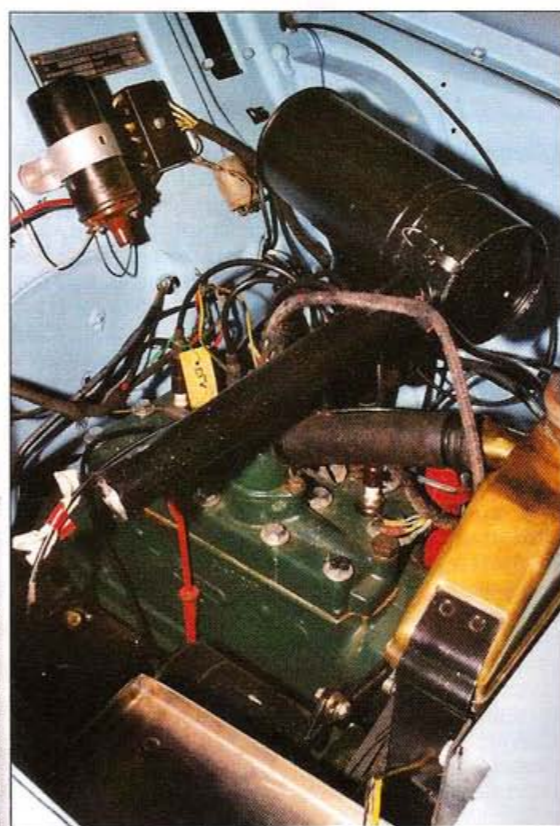
Sous le capot, c'est le petit 4 cylindres des années 30 qui anime la 12M. Pas très violent, mais vaillant.
